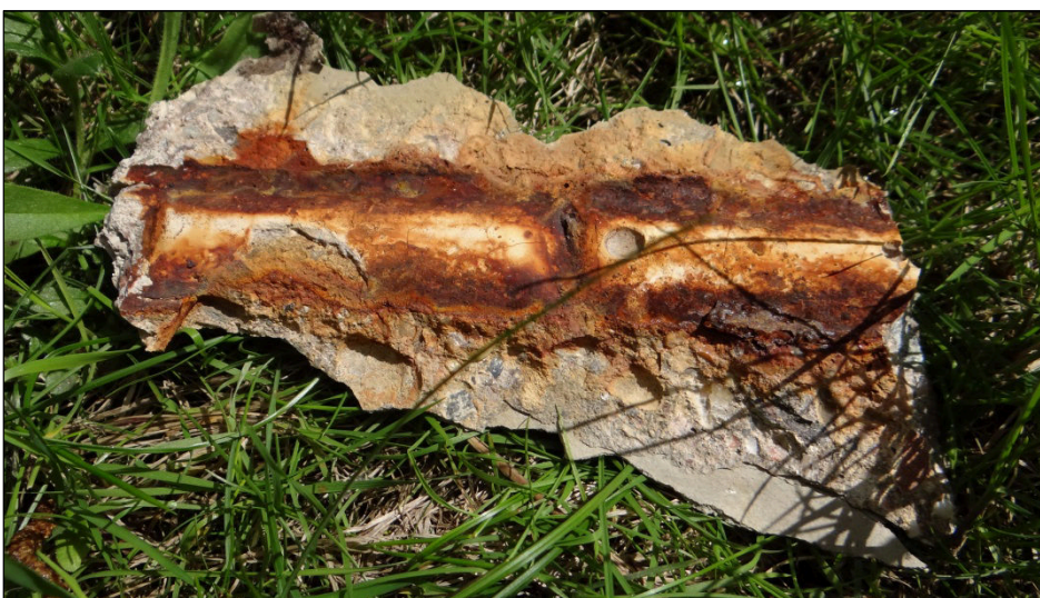
Obr. 26 Odpadlá krycí vrstva betonu
