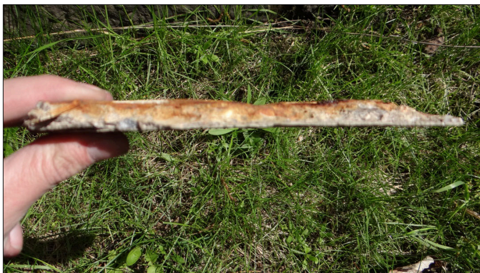
Obr. 28 detail tloušťky krycí vrstvy
