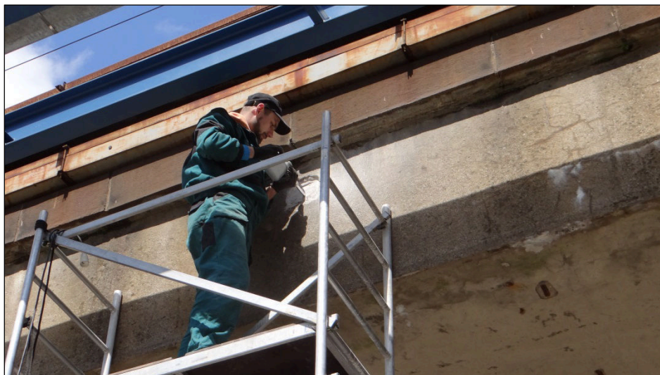
Obr. 15 Provedení tvrdoměrné zkoušky betonu
