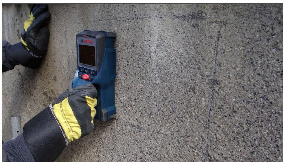
Obr. 16 Elektromagnetický detektor betonářské výztuže – bok nosné konstrukce
